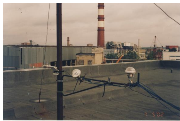
Joonis 9. Päikesekiirguse sesoonne mõõtmine TEFI Mustamäe korpuse katusel
