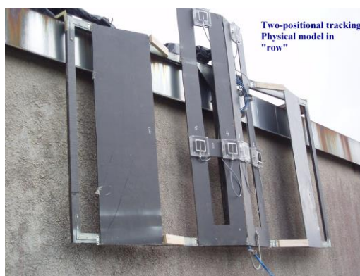
Joonis 11, Kahepositsiooniliselt eksponeeritava heliofarmi mudel
