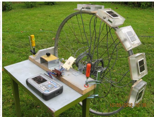
Joonis 16 “Mõõteratas” kogukiirguse mõõtmiseks kaldpindadel
