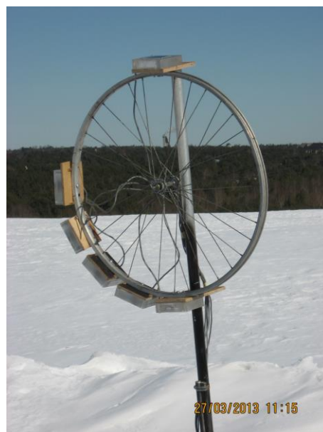
Joonis.18. Peegeldunud kiirguse mõõtmine lumel Pääsküla prügimäel
