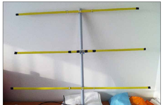
Antennitöötoa tulemus: igati kasutatav 2m yagi!
