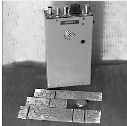
UR2RKI poolt 1986.a. valmistatud 2m FM-käsijaam
