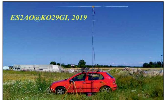
ES2AO võistluspositsioon enne tuuri algust. Tegelikult kasutatud (lühike) yagiantenn on auto ees montaažipakil, aga sulab kokku auto akrajoonega. Vaade on ida suunas, taustal ehitusmaterjalide ladu.
