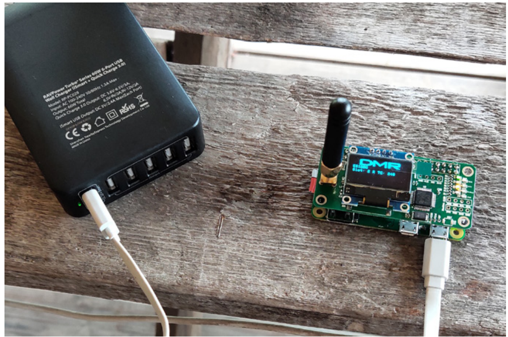
DMR-hotspot: MMDVM ja Raspberry Pi Zero.
